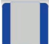
Aislamiento en poliuretano de alta densidad 38/40kg/m<sup>3</sup> con un espesor de 60/70 mm libre de CFC, HCFC (Según uso)
